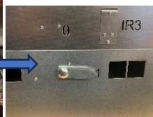
Après avoir connecté l'alimentation du piège, tournez le verrou du bac à rat vers la droite, en position 1, en maintenant une distance de sécurité pour éviter de vous blesser lors des ouvertures et fermetures des portes et pièces mobiles. Soyez attentif, car le piège se ferme et s'ouvre instantanément avec un claquement puissant. Les personnes ou animaux sensibles à proximité peuvent être surpris.
